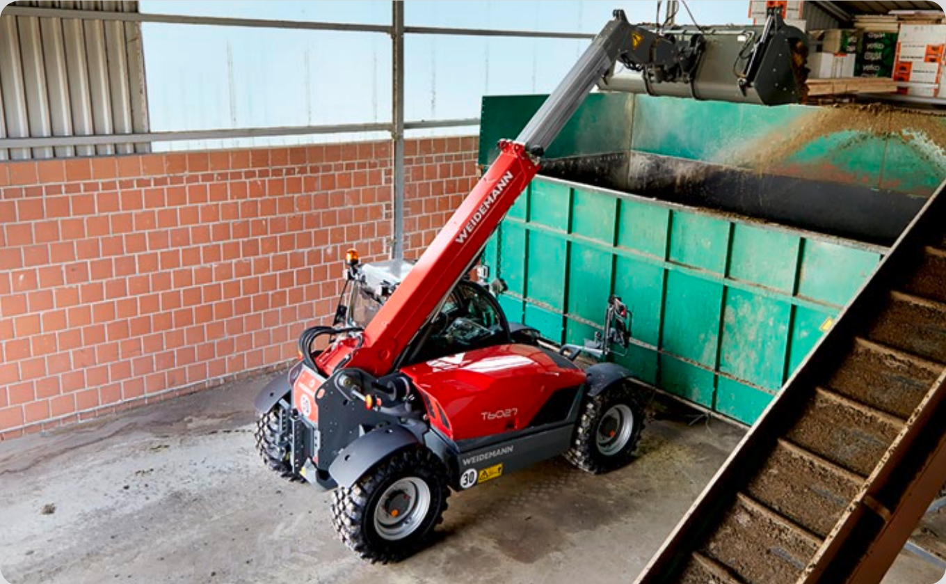
Система автоматического возврата ковша (опция для модели T6027). Путем нажатия соответствующей кнопки на джойстике возможно сохранение положения крепления. При следующей загрузке навесное оборудование возвращается в то же самое положение. Благодаря этому система автоматического возврата ковша повышает комфорт, точность и скорость работы водителя при повторяющихся работах, таких как штабелирование или заполнение емкостей.
