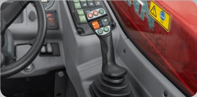
Джойстик для моделей T5522 и T6027. Джойстик становится универсальным устройством и еще больше повышает удобство управления машиной. Наряду с функцией 3-го пропорциональным режимом управления 3-го контура, регулируемого джойстиком, при помощи перекидного выключателя можно также включать непрерывный режим работы 3-го контура управления при помощи тумблера – путем перемещения колесика в обоих направлениях. Возможно также пропорциональное управление функцией телескопирования. Дополнительно обе электрические функции можно активировать посредством нажатия или фиксации соответствующих элементов на джойстике. При этом обе электрические функции не зависят друг от друга, так что водитель может задавать их конфигурацию индивидуальным образом.
