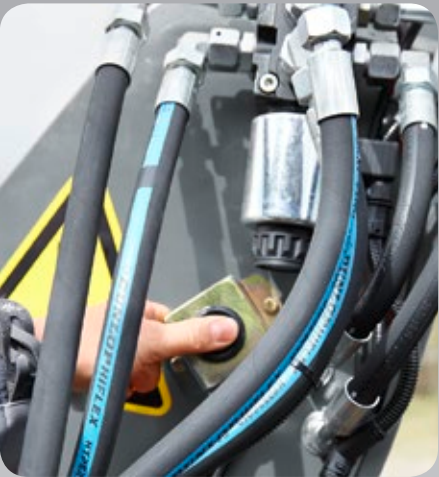
Сброс давления, 3-й контур управления (опция). Для подсоединения и отсоединения навесного оборудования с гидравлическим управлением в телескопических погрузчиках T5522 и T6027 применяется инновационное решение: кнопка для сброса давления в 3-м контуре управления легко доступна снаружи на телескопической стреле. Тем самым различное навесное оборудование можно заменять еще быстрее и эффективнее. Замена может происходить даже при включенном зажигании и работающем двигателе.
