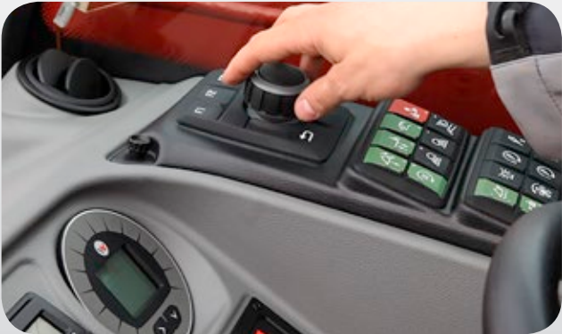
Регулирование количества гидравлического масла (T6027). При необходимости при помощи элемента управления «Jog Dial» возможна ручная настройка расхода гидравлического масла. Это решение весьма полезно, если машина приводит в действие гидравлическое навесное оборудование, для которого не требуется полная гидравлическая мощность машины. За счет этого обеспечивается высокая точность и экономичность при работе с машиной и навесным оборудованием.
